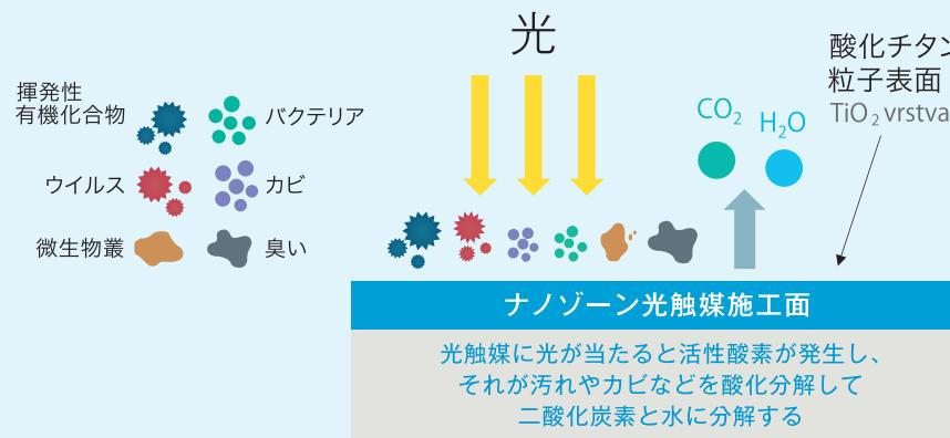
1967年に日本で発見された『世界に誇る環境技術』です。酸化チタンに光が当たると、空気中の酸素や水分、または水に反応しその酸化チタン表面で活性酸素または活性水酸基が発生します。それらが酸化チタンに接触する有機物(臭い・菌類・ウィルス・VOCガスなどの有害物質)を酸化分解あるいは分解減少させます。
